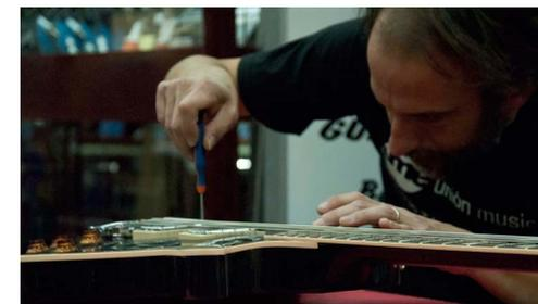
Para comprobar la curvatura del mástil ejercemos presión sobre el traste 1 y el último de nuestro instrumento y en la zona central sobre los trastes 7 y 9 observaremos que la cuerda quedará levantada varios milímetros, entre 0,3 y 1 mm se podría considerar un ajuste estándar.
