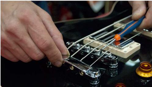
En el bajo que estamos ajustando nos encontramos con que no tiene el clásico puente de silletas independientes para cada cuerda, sino que tiene un puente fijo en el que la altura de las cuerdas ya vienen definidas conforme al radio del diapason y mediante dos puntos situados uno a cada lado del puente nos permite regular su altura sobre el mástil.
