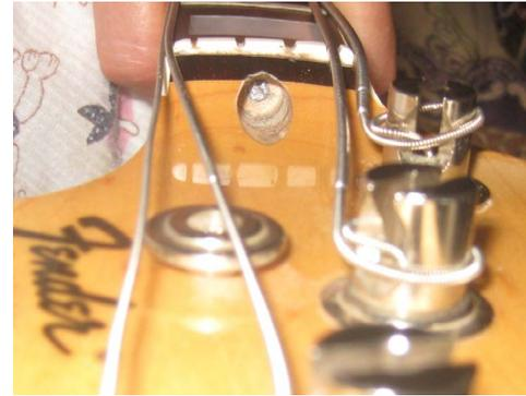
el mástil estaba bastante curvado y requería tensar bastante la varilla para volverlo al sitio, por otro lado a que el alma estaba pegada al canal que la aloja, debido seguramente a un exceso de adhesivo, esto hizo que al intentar tensarla y no obtener resultado se sobretensara demasiado, al final después de apretar en exceso se partió la varilla .
