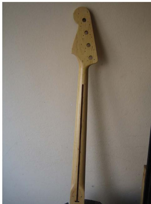
Con el mástil ya totalmente lijado, el diapasón y la pala tapados con cinta, ya estaba listo para ser repintado y dejarlo immaculado, después del proceso de barnizado, posterior secado, lijado al agua y pulido, el mástil estaba ya listo.
