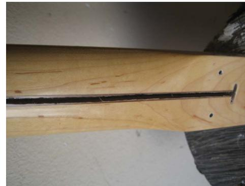
Con una fresadora tipo Dremel fuimos eliminando parte de la madera de la “cola de mofeta” que cubre el canal del alma, es una tarea delicada ya que en
