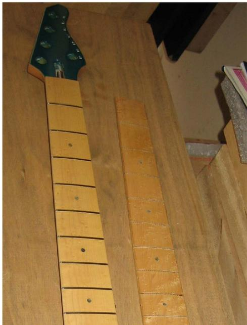
Era hora de colocar el nuevo diapasón, dejándolo encolar con los gatos colocados durante unos días, después de reparar el diapasón y comprobar su radio y superficie llegó la hora de colocar trastes nuevos nivelarlos y barnizar el mástil para dejarlo acabado.
