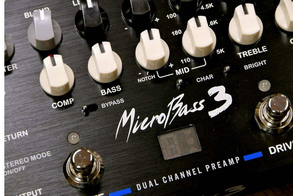
el sonido puro y definido de EBS de siempre, mientras que el canal Drive nos entrega una saturación que se nos antoja muy mejorada y realmente útil. Lógicamente cada canal tiene su ecualización diferenciada y además de un control Drive que controla la cantidad de saturación, el control Blend se encarga de mezclar ambas señales a voluntad, pudiendo por ejemplo elegir una saturación poderosa pero mezclada en un porcentaje bajo respecto al sonido limpio.
