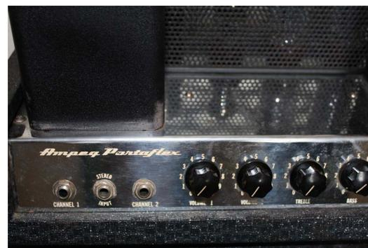
Fue el amplificador que por fin daba el sonido que el bajo eléctrico llevaba sin encontrar durante casi una década de existencia: grueso y lleno de fundamentales gracias a la calidez de sus seis válvulas (tres de preamplificación y tres de amplificación) y a un baffle doble cerrado por detrás, con un único altavoz de 15 pulgadas y diseñado teniendo en cuenta
