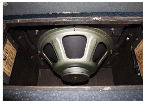
Los paneles laterales podían quitarse para cambiar la tonalidad en caso de utilizarse con un contrabajo. Así mismo, uno de ellos albergaba el conector octal donde se conectaba el cable que mandaba la señal del cabezal al baffle.
