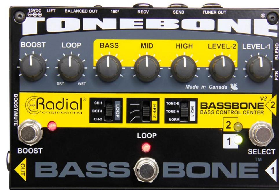
cesada a través del loop de efectos. A continuación nos encontramos con los tres potenciómetros del ecualizador de 3 bandas del canal 2 con los siguientes rangos de trabajo, en graves +/- 12dB sobre los 75 Hz, en medios +/- 10dB en los 470 Hz y en agudos +/- 16dB sobre los 5,6 KHz.
