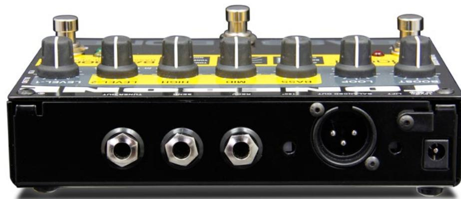
El Bassbone nos permite al conectar estos dos instrumentos el equiparar el volumen de salida e incluso la ecualización de uno de ellos para no tener que retocarla en directo del amplificador.
