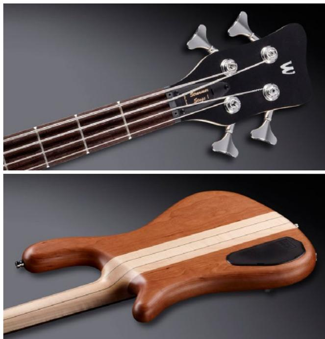
*El Streamer Stage I es de construcción neck through, con el mástil a través del cuerpo, con las alas de este abovedadas de cerezo americano y un mástil de tres piezas de arce con dos bandas de Ekanga y perfil en "C".*
