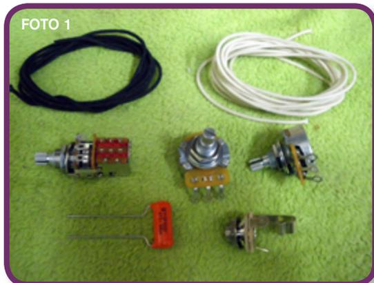
A continuación desmontamos toda la electrónica vieja. Luego vamos a tener que ensanchar los agujeros del controlplate para lo que utilizaremos una broca de 9.5mm, ya que los que monta son de menor calidad y su anchura es inferior (broca 7.5mm). Una vez tenemos listo el controlplate montamos la electrónica nueva y procedemos a soldarla. **FOTO 2**
