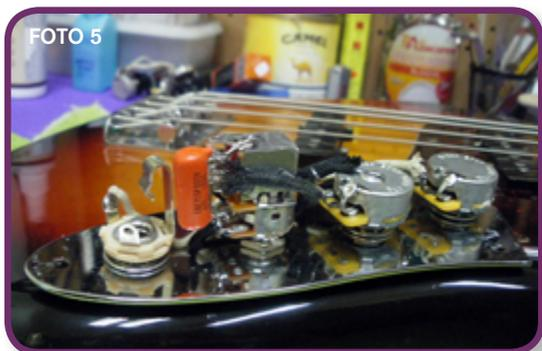
En este caso le instalamos un condensador Orange Drop de 0.047uf. El valor de condensador funciona como un filtro, cuanto más alto sea el valor más frecuencias agudas recorta, el recomendado es 0.047uf pero podéis probar 0.033uf y 0.022uf para poder valorar cual os gusta más. **FOTO 6**
