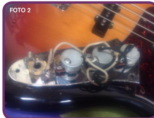
En este caso vamos a utilizar el push/pull para que las pastillas funcionen en serie o en paralelo y así poder obtener otro sonido que puede ser interesante, ya que cuando levantamos el potenciómetro las pastillas funcionan en serie y se activa un Booster de medios que consigue que las sonoridades se aproximen a las emitidas por un Precision Bass y por otro lado con el potenciómetro bajado obtenemos el clásico sonido Jazz Bass con las pastillas funcionando en paralelo. **FOTO 3**
