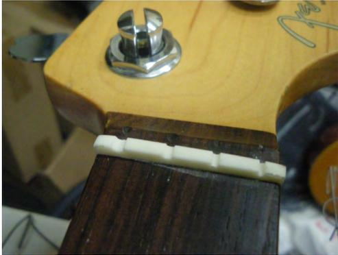
La altura idónea sería la que nos marcaría pulsando la cuerda en el traste 3, donde tendríamos que tener una distancia desde el traste 1 a la parte inferior de la cuerda de 0,20mm.
