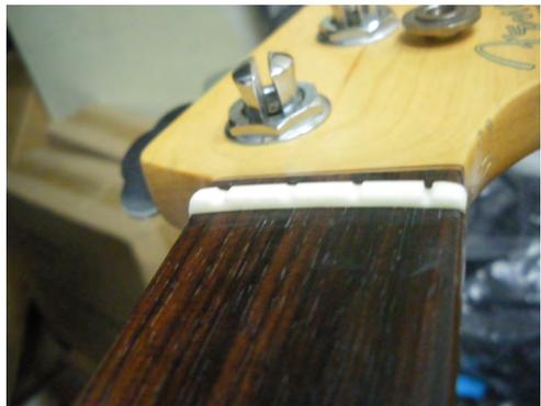
Para conseguir esta altura tendríamos que ir comprobando poco a poco e ir limando hasta conseguirlo. El surco de la cuerda tiene que ir un poco inclinado a la salida de la cuerda para coger el ángulo de la pala.
