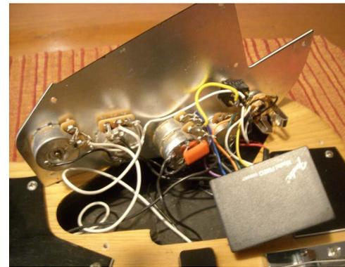
Tenemos que añadir el condensador .05uF a este pote conectándolo por un extremo al circuito de masas y por el otro a la patilla central del pote. Se puede sustituir el condensador por uno de .022uF que es el valor original según las especificaciones técnicas de Fender
