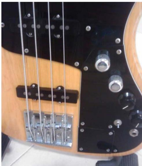
Replanteamos el cableado del switch de forma y manera que los cables (blanco-salida y amarillo-entrada) del previo vayan conectados en la posición activo "ON" haciendo que no intervengan cuando cambiemos el switch a posición activo "OFF".
