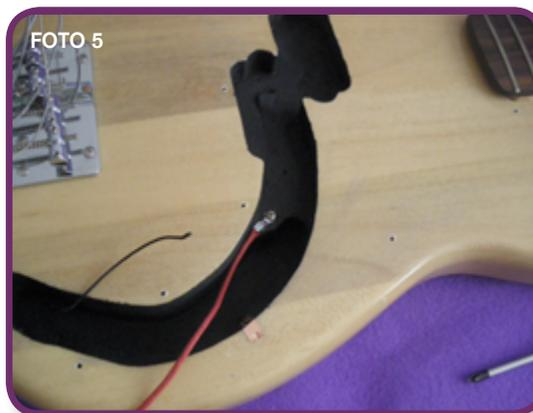
Una vez tenemos el golpeador listo y el grafito seco, cortaremos unas tiras de cobre que pegaremos al routing de la pastilla para que haga contacto con el grafito y el cobre del golpeador, pondremos a su vez otro trocito en el routing del controlplate.
