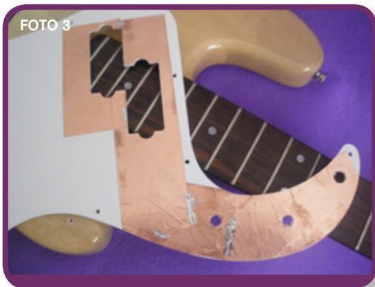
Por último cogeremos un cable y le pondremos un terminal para atornillarlo al cuerpo, lo soldaremos después a masa. Como tenemos pintura le daremos una manita al terminal y al tornillo para asegurarnos que está todo bien conectado a masa. Con la ayuda de un tester comprobaremos que existe continuidad en todos los puntos, de manera que nos confirme que el trabajo realizado es eficaz y cumple su objetivo.
